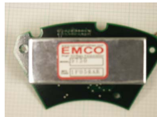
EMCO HV Generator
